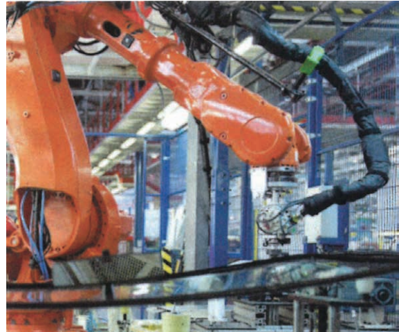
・動作の早いロボットのホース・ケーブルの保護として使用可能です
