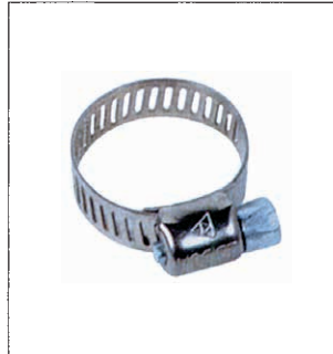
MH タイプ バンド SUS303 ハウジング SUS303 ボルト SS 板巾：7.9mm
