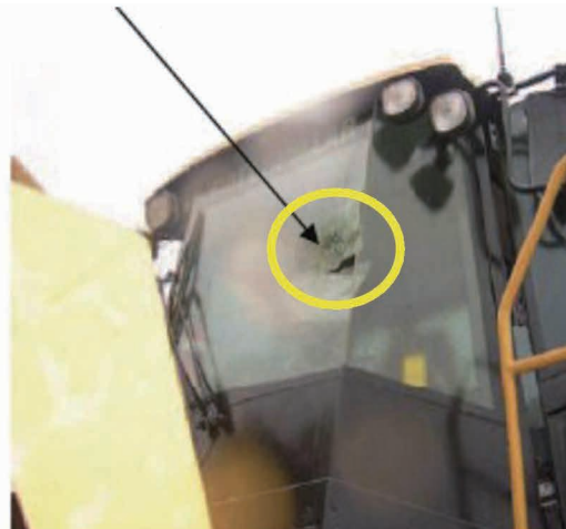
Oil Hit Glass Here (オイルによるガラス破損部)
